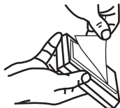
Placera kontrollenheten med dubbelsidig tejp.
