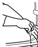
Lägg sladdarna åtsittande för att undvika fult utseende
