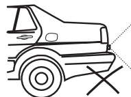
Far attenzione che altre parti del veicolo non cadano in prossimità del sensore per evitare segnali errati.
