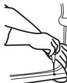
Leg de draden op een beschutte plek om beschadiging van de draden te voorkomen.
