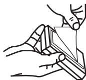
Posizionare l'unità di controllo con del nastro biadesivo.
