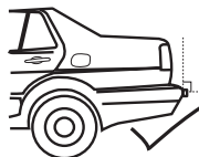
Far attenzione che altre parti del veicolo non cadano in prossimità del sensore per evitare segnali errati.
