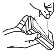
Zamontuj główne urządzenie za pomocą dwustronnej taśmy klejącej
