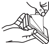
Plaats het schakelkastje met de dubbelzijdige tape.
