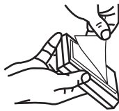
Befestigen Sie die Kontrolleinheit mit doppelseitigem Klebeband.
