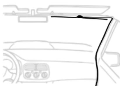
*Non fissare l'antenna DAB sopra i fili del radiatore, in un punto che possa ostacolare la vista del conducente, o che possa ricevere interferenze dal metallo. Per la propria sicurezza, non far passare i cavi in modo da interferire con il funzionamento del veicolo, né attraverso un percorso che possa interferire con la funzionalità degli airbag.*
