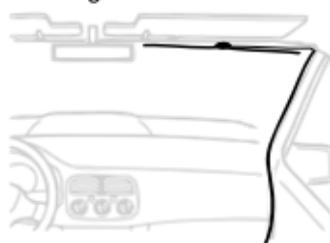
*Aus Sicherheitsgründen verlegen Sie die Kabel nicht so, dass sie den Betrieb des Fahrzeuges stören, oder an einer Stelle, welche die Funktionsfähigkeit der Airbags beeinträchtigt.*
