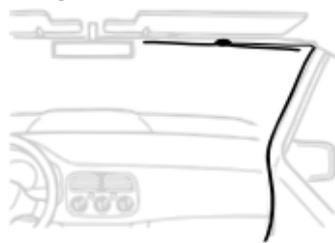
donde puedan obstruir la visión del conductor, ni en un lugar donde reciban interferencia de parte de elementos metálicos. Por su seguridad, no pase cables de manera tal que interfieran con la operación del coche, ni tampoco los pase a través de un lugar donde interfieran con el funcionamiento de las bolsas de aire.
