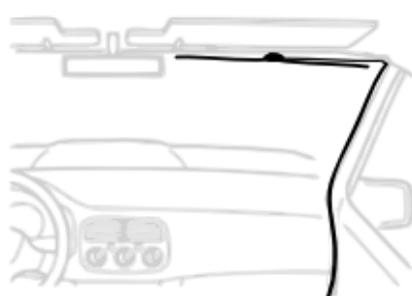
*Não fixe a antena DAB por cima dos fios do aquecimento, num local onde possa obstruir a visão do condutor, ou num local que possa receber interferências de metal. Para sua segurança, não instale os cabos de modo a que possam interferir com a operação do veículo, nem através de um local onde possam interferir com o funcionamento dos airbags.*
